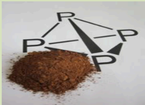
Klärschlammasche Phosphorverbindung schwerlöslich
